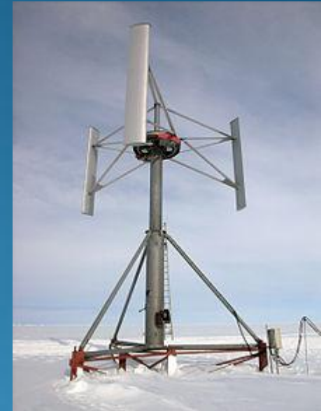
Windanlage in der Antarktis (Keine Rotoren wegen Vereisung).
